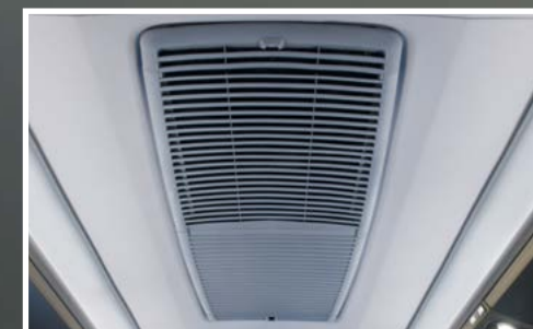
Rejilla de aire acondicionado integrada al techo
