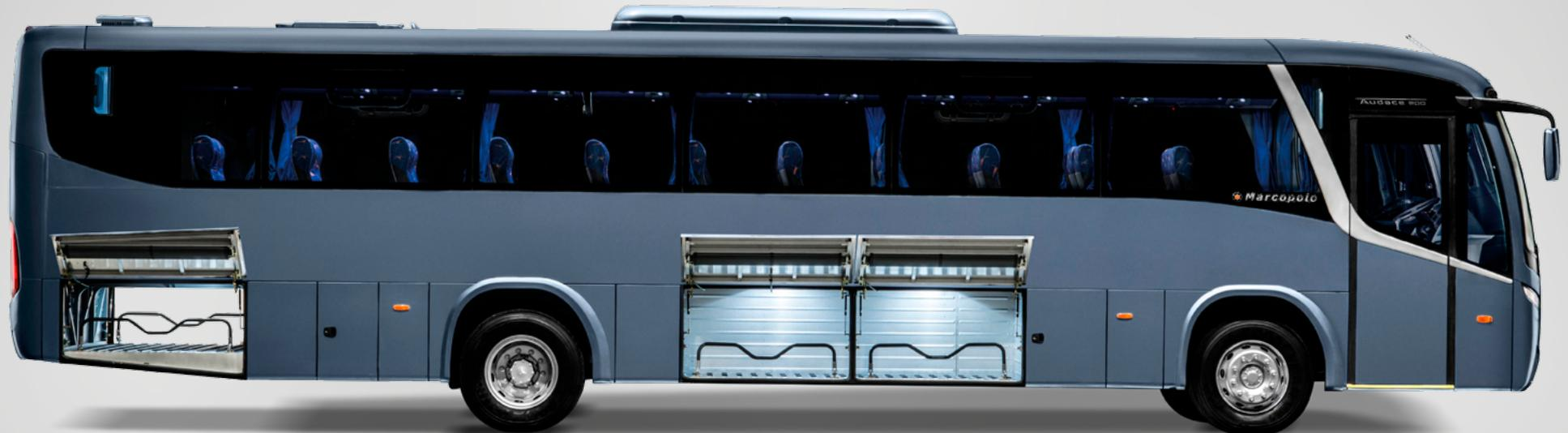
Altura: 3.260mm (sin aire acondicionado) | Ancho: 2.550mm | Longitud: 12.700mm a 13.500mm
