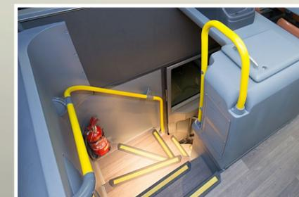
Escaleras de acceso más amplias, con perfiles inyectados e iluminación indirecta
